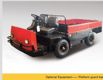
Optional Equipment——Platform guard bar
