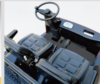
Optional Equipment——Platform guard bar
